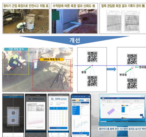
[ 말뚝 향타 관입량 무인 측정 ]
